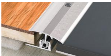
Übergangprofil für Bodenbeläge von 7–18mm, inklusive Neigungsverstellung von 4–21mm
