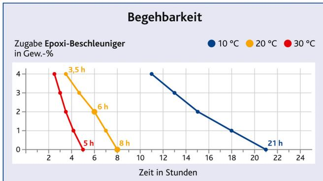
Eine Zugabemenge von 2 % macht Sinn, um an einem Tag zwei Schichten auftragen zu können.
